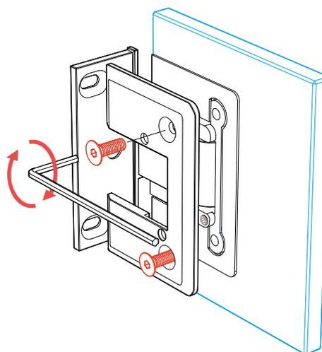
4) Avvitare la piastra al corpo tramite le viti di fissaggio.
