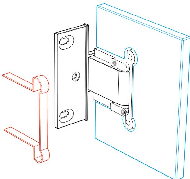
2) Per evitare scivolamenti della porta, per mezzo della guarnizione interna e/o di materiali morbidi (pvc, gomma, ecc) o colando adesivo termofusibile, riempire gli spazi tra tacca vetro e corpo sagomato. Il peso del vetro deve gravare sul corpo cerniera e non essere sostenuto dalla pressione del coperchio.
