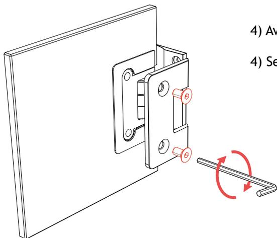
4) Avvitare la piastra al corpo tramite le viti di fissaggio.
