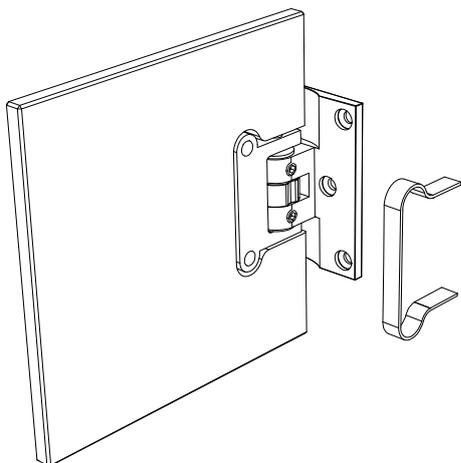
2) Per evitare scivolamenti della porta, per mezzo della guarnizione interna e/o di materiali morbidi (pvc, gomma, ecc) o colando adesivo termofusibile, riempire gli spazi tra tacca vetro e corpo sagomato. Il peso del vetro deve gravare sul corpo cerniera e non essere sostenuto dalla pressione del coperchio.
