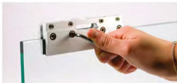
Avvitare le quattro viti di serraggio alla coppia prestabilita di 8 Kn utilizzando la chiave dinamometrica CDK01
